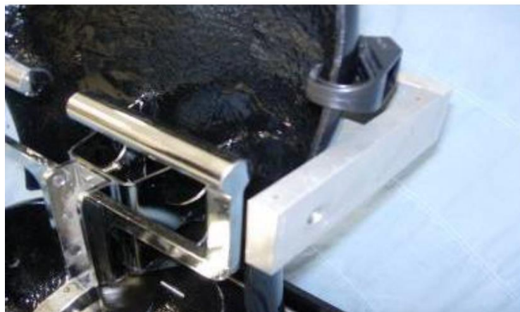
圖 17：以支撐帶固定 HPM 背板
