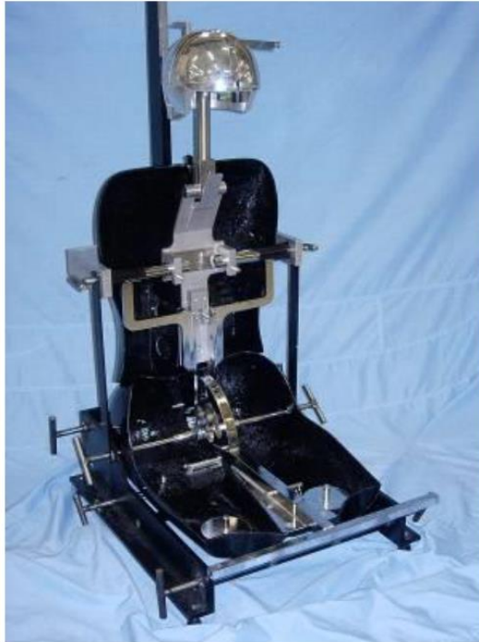
圖 20：HPM 安裝於校正治具上並使用支臂支撐 H 點
