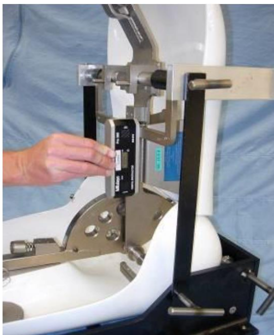
圖 22：使用數位傾斜儀量測軀幹配重支架之軀幹角度
