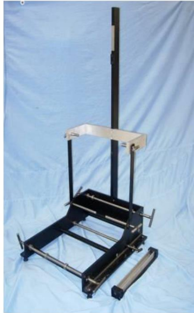
圖 14：HPM/HRMD 校正治具（GLORIA）
