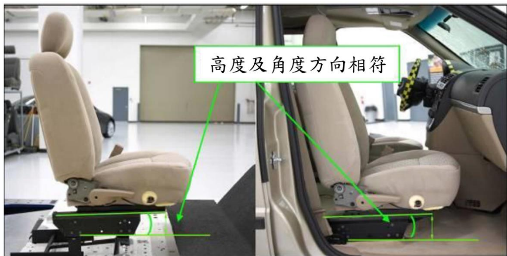
圖 4：試驗台車之座椅安裝
