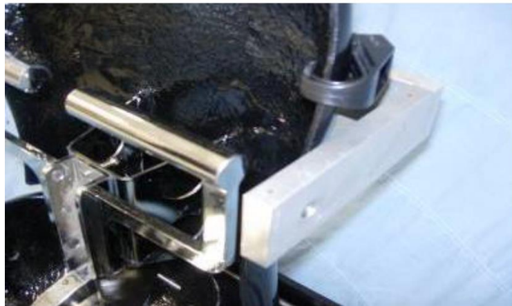
圖 17：以支撐帶固定 HPM 背板
