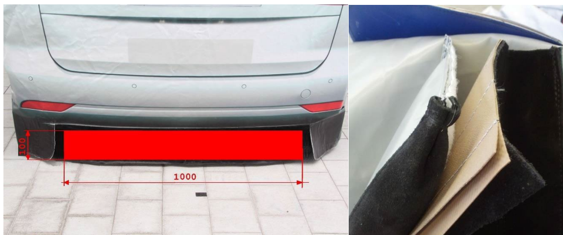
圖 16：左側圖片為目標車之前視圖，包括下側雷達吸收墊之位置；右側圖片為不同層之吸收墊
