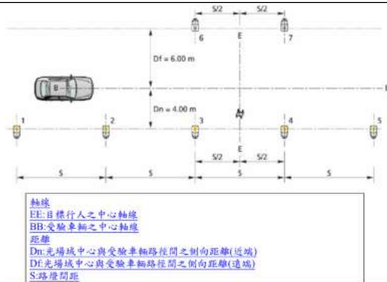
圖15c：近端成人碰撞情境試驗-晚上設定
