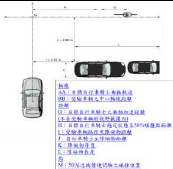
圖14l：近端自行車騎士障礙物碰撞情境試驗，自行車騎士騎乘自近端穿越其路徑
