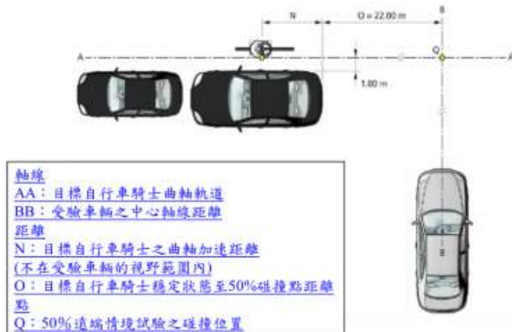
圖14j：遠端自行車騎士碰撞情境試驗，自行車騎士騎乘自遠端穿越其路徑
