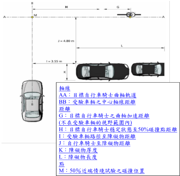
圖141：近端自行車騎士障礙物碰撞情境試驗，自行車騎士騎乘自近端穿越其路徑
