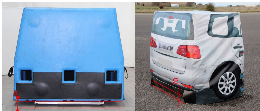
圖 17：目標車前視圖，標示距地面之距離
