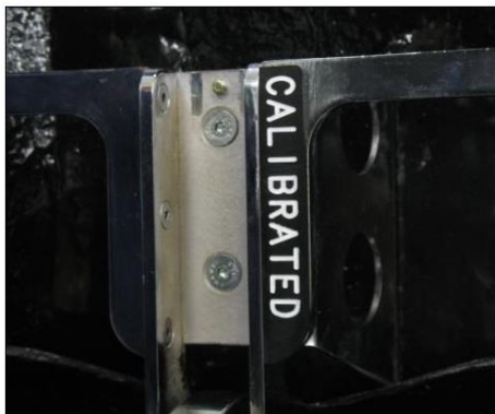
圖 25 ：校正用軀幹角度量測墊塊與軀幹配重支架連接
