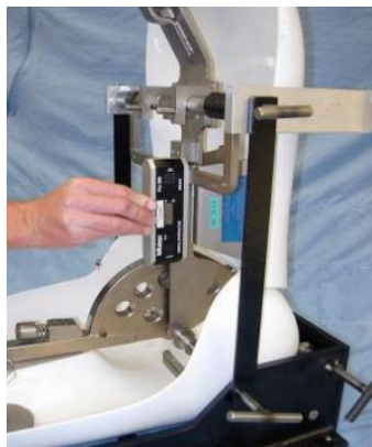
圖 24 ：使用數位傾斜儀量測軀幹配重支架之軀幹角度
