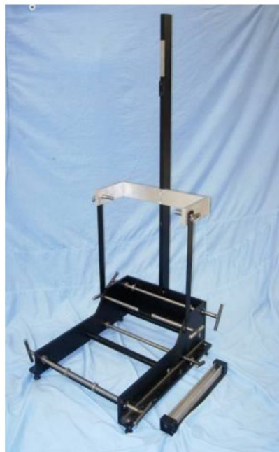
圖 14：HPM/HRMD 校正治具（GLORIA）
