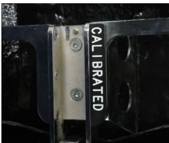
圖 23：校正用軀幹角度量測墊塊與軀幹配重支架連接
