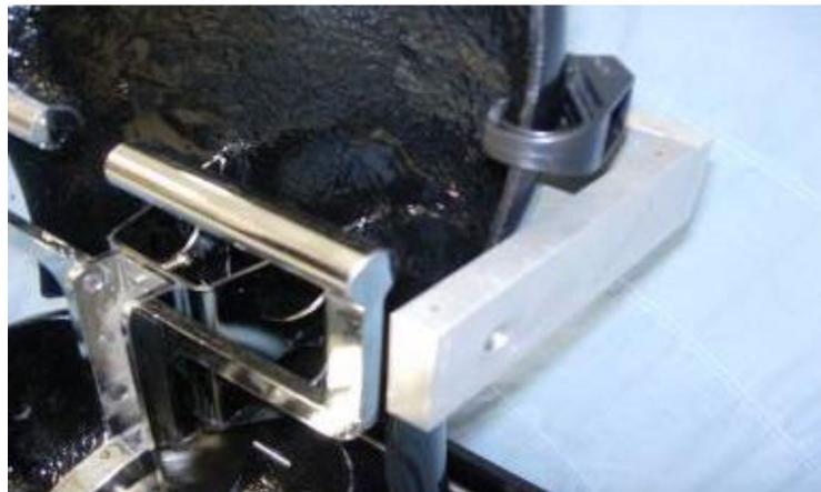
圖 17：以支撐帶固定 HPM 背板
