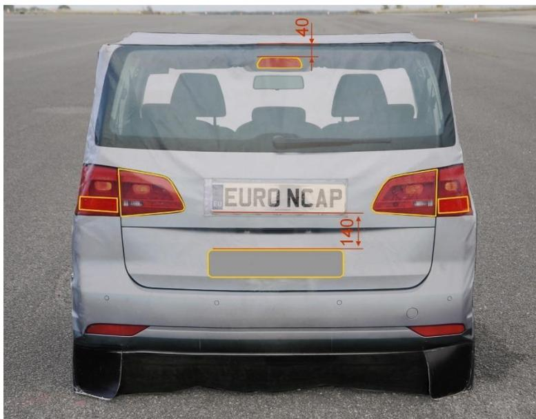
圖 15：目標車前視圖，包括復歸反射膜之位置
