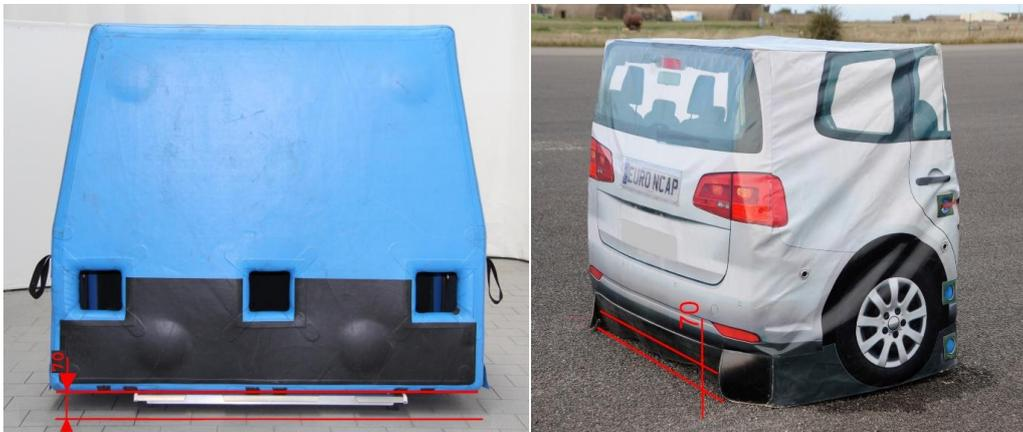
圖 17：目標車前視圖，標示距地面之距離
